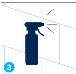
Untergrund mit **«AKEMI Crystal Clean»**-Spray reinigen (nach Hersteller-Anleitung). Mit Wasser nachspülen und abtrocknen.
