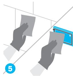
Untergrund und Adesio-Wandflansch mit **3M VHB Surface Cleaner** oder Propylalkohol reinigen.
