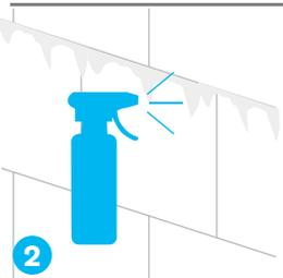
Sind gut sichtbare **Kalkablagerungen** vorhanden, so sind diese mit dem sauren Reinigungsmittel **«AKEMI Sanitärreiniger»** zu entfernen (nach Hersteller-Anleitung). Mit Wasser nachspülen.
