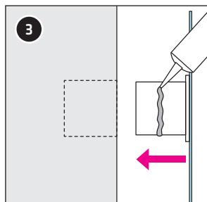
Die zu beklebende Stelle bei der UP Fixbox reinigen. Kleber auf UP Fixbox mittig auf tragen und in Loch drücken.
