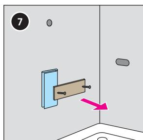
Ca. 1 Stunde trocknen lassen (Kleber quillt auf). Fixationsvorrichtung und Schrauben nach Aushärtung des Klebers entfernen.
