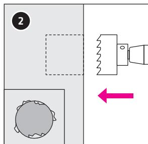
Mit Kronenbohrer Loch ausschneiden. Ausschnitt von losen teilen reinigen.
