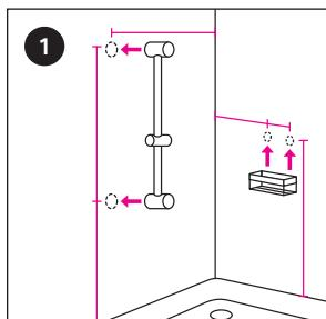
Position der Garniturenmontage bestimmen. **WICHTIG:** Keine Ständerkonstruktion hinter Lochbohrung.
