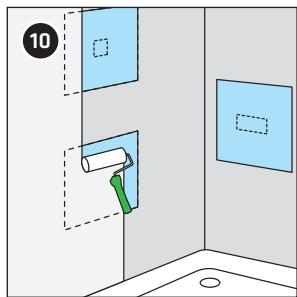
Vverbundabdichtung an der Wand anbringen und vormontiertes Dichtvlies einarbeiten. Lieferantenangaben beachten.
