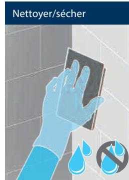
Nettoyer la surface de contact avec le chiffon 1 et sécher avec le chiffon 2.
