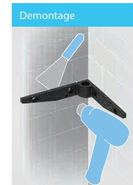
Wandflansch mit Heissluftföhne bei ca. 200 °C erwärmen und mit Spachtel vorsichtig lösen.
