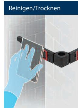
Klebefläche in Wandflansch reinigen und trocknen.
