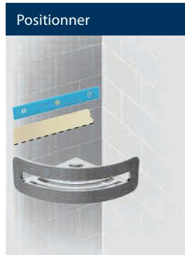
Déterminer approx. la position du support de douche (par ex. scotch). Eviter les joints.
