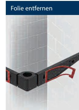
Schutzfolie von Wandflansch entfernen.
