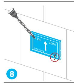
Klebstoff in Einfüllloch (oben) einpressen bis er unten austritt.
