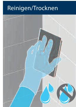
Kontaktfläche mit Tuch 1 reinigen & Tuch 2 trocknen.
