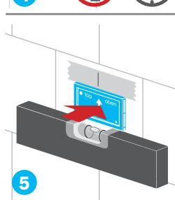
Schutzfolie abziehen. Flansch auf Wasserwaage waagrecht an Wand schieben.
