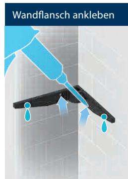
Klebstoff in Einfüllloch (gross) pressen, bis Klebstoff an Loch (klein) austritt.
