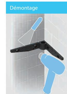
Chauder avec un pistolet à air chaud à 200 °C environ et détacher à l'aide d'une spatule.
