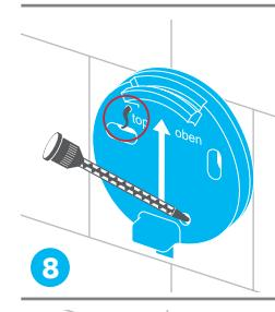
Injecter la colle dans le trou de remplissage (en bas) jusqu'à ce qu'elle s'écoule par le haut.
