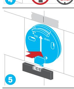
Schutzfolie abziehen. Flansch auf Wasserwaage waagrecht an Wand schieben.
