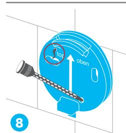
Klebstoff in Einfüllloch (unten) einpressen bis er oben austritt.
