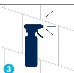
Pulire il substrato con lo spray **«AKEMI Crystal Clean»** (secondo le istruzioni del produttore). Sciacquare con acqua ed asciugare.
