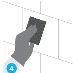
Fläche mechanisch mit einem rotbraunen **3M Schleifvlies** (very fine) reinigen.
