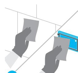
Pulire il substrato e la flangia murale Adesio con **3M VHB Surface Cleaner** oppure alcool propilico.
