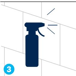
Untergrund mit «**AKEMI Crystal Clean**»-Spray reinigen (nach Hersteller-Anleitung). Mit Wasser nachspülen und abtrocknen.
