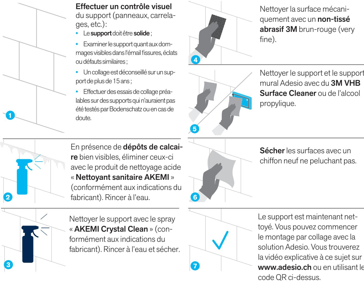
**Effectuer un contrôle visuel** du support (panneaux, carrelages, etc.):
