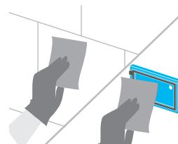
Untergrund und Adesio-Wandflansch mit **3M VHB Surface Cleaner** oder Propylalkohol reinigen.
